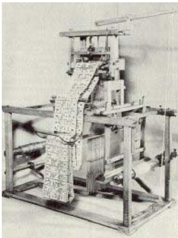
*L'immagine a fianco rappresenta il telaio di Jacquard. La sua importanza risiede nel fatto che fu il primo telaio nei primi anni del 1800 ad automatizzare le procedure con l'introduzione delle schede perforate. È uno dei primi esempi di procedura algoritmica con applicazione binaria.*
